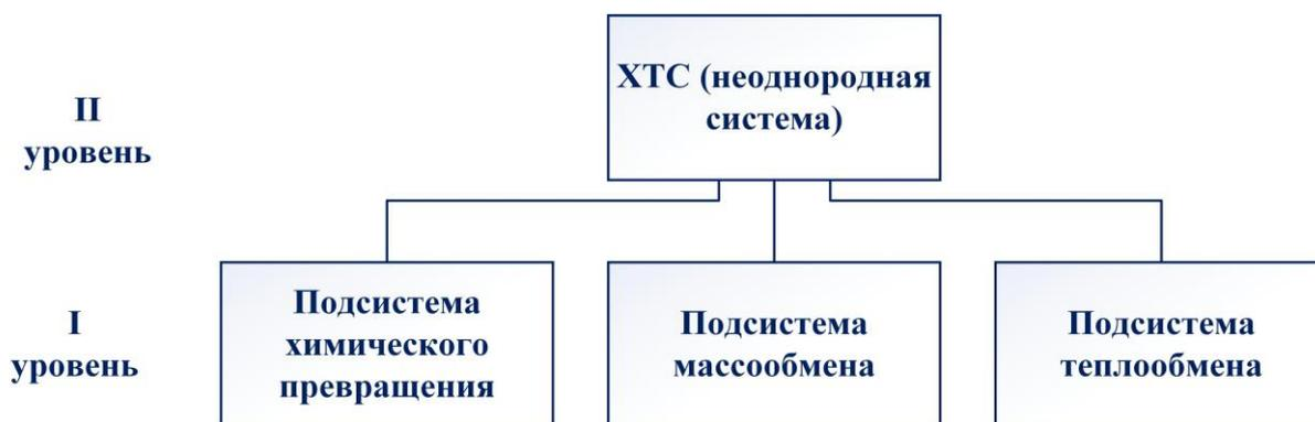
Рис. 1. Иерархическая структура ХТС для целей термодинамического анализа.
