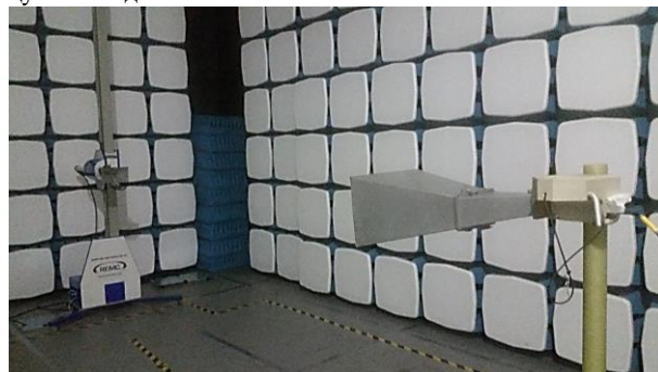
4-расм. ЭЭҚда П6-23А антеннаси техник характеристикаларини ўлчаш жараёни
