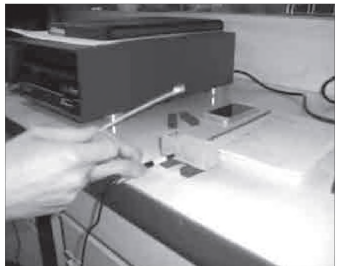
Рис. 8. Пропуск звуковой волны через опытный образец мастики.
