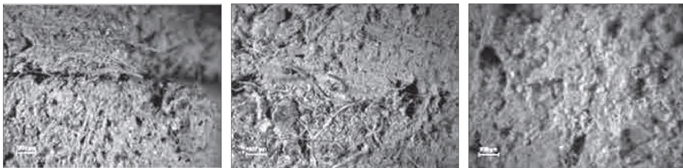
Рис.9 (а): R1, в структуре имеется сильное растрескивание /LRMH©/ Рис. 9(б): R5 в структуре имеются микротрещины /LRMH©/ Рис. 9(в): R3 структура мастики однородная, не наблюдается появление трещин при высыхании /LRMH©/ Fig.9 (a): R1, strong cracking in structure /LRMH©/ Fig.9 (b): R5 micro cracks in structure /LRMH©/ Fig.9 (c): R3 homogeneous structure of mastic, no cracks at drying /LRMH©/
