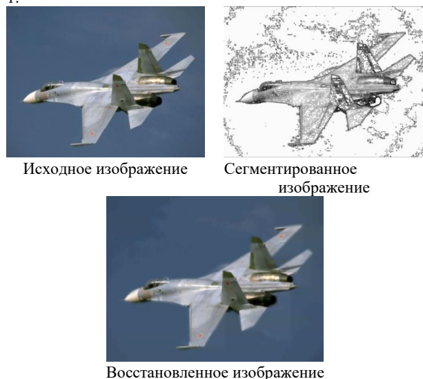
Рис.1. Вариант исходных, сегментированных и восстановленных изображений при 32 уровневом квантовании.
