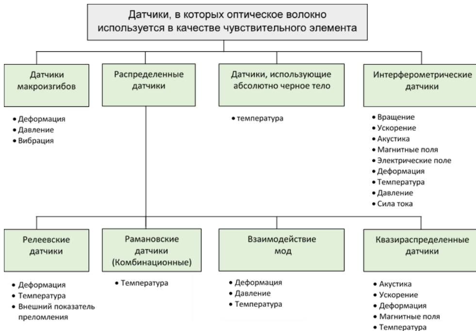
Рис. 11. Датчики, в которых оптическое волокно используется в качестве чувствительного элемента, или «чистоволоконные» датчики
