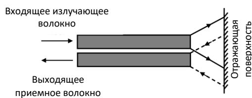
Рис. 14 (а) Двухволоконный датчик отражательного типа и (б) его типичная характеристика
