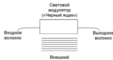
Рис. 10. Принцип внешних волоконно-оптических датчиков
