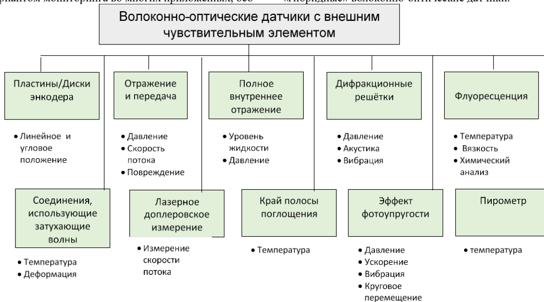
Рис. 9. Волоконно-оптические датчики с внешним чувствительным элементом или гибридные: свет передается на вход чувствительного элемента и принимается с его выхода с помощью волокна
