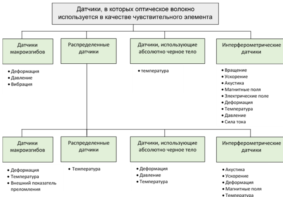
Рис. 12. Основные виды интерферометрических волоконных датчиков
