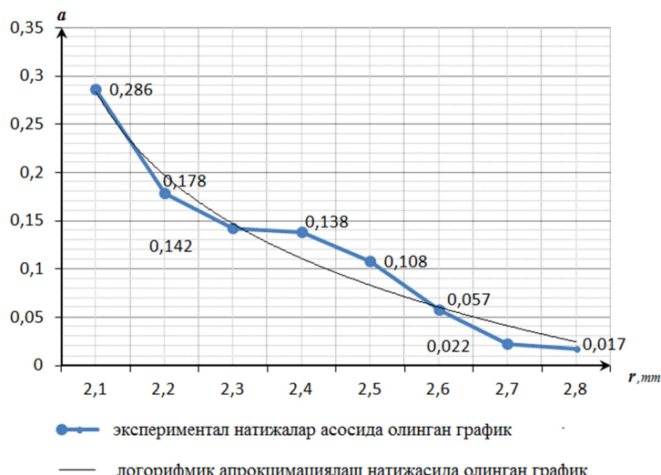
4-расм. Тола оптик йўқотиш коэффициентининг унинг эгилиш радиусига боғлиқлигини экспериментал тадқиқи натижасидаги график ва унинг логорифмик апроксимацияси
