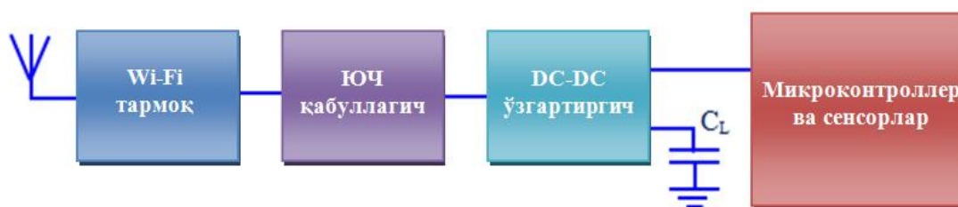
4- расм. Симсиз зарядлашнинг тузилиш схемаси
