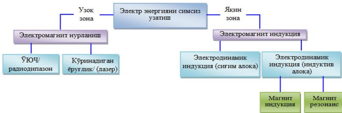
2- расм. Аккумуляторларни зарядлаш учун ишлатиладиган электр энергияни симсиз узатиш технологиялари
