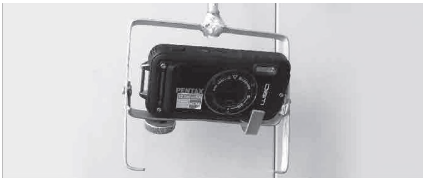
Рис. 5. Пример челнока для наклонных снимков.
