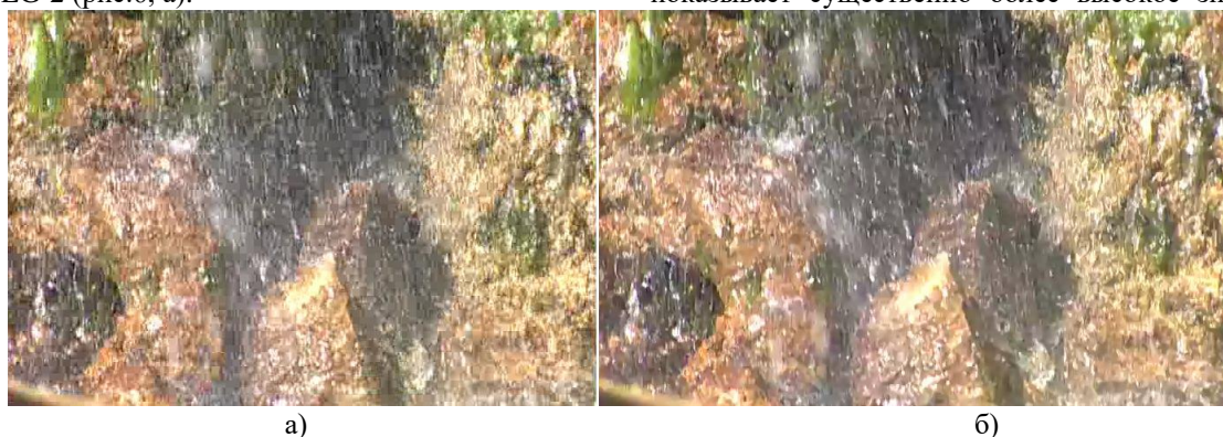
Рис.6 Визуальное качество изображений видеосюжета «Водопад» кодированных кодеками стандартов MPEG-2 (а) и H.264 (б) с битрейтом 2 Мбит/с
