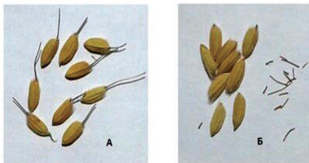
6-расм. Қури-тиш қурилмасида шолини шнек орқали ўтишидан олдинги (А) ва кейинги (Б) ҳолати
