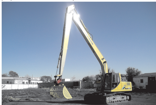
Рис.2. Ковш-косилка сегментным режущим аппаратом, навешанный на однокосовый гидравлический экскаватор зарубежного производства
