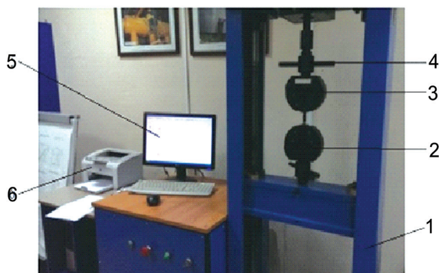
1-рама; 2-нижний захват; 3-верхний захват; 4-дисплей компьютера; 5-принтер
