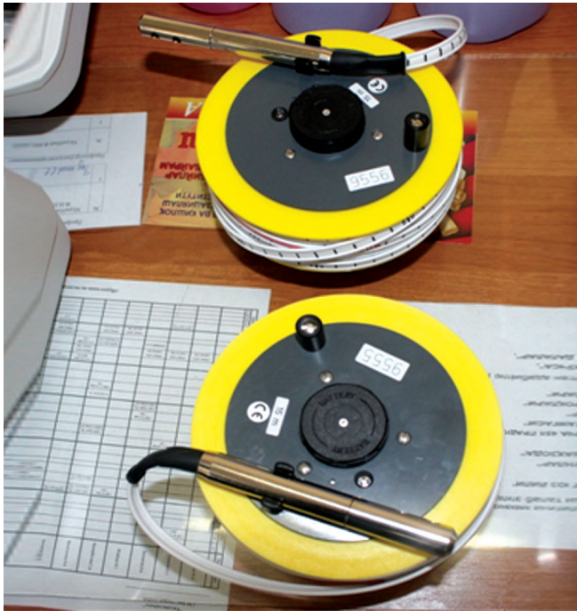
2-расм. Ер ости сизот сувлари сатҳини ўлчовчи мослама (SEBA- Kabellichtlot Typ KLL-Mini Messbereich 15 м)
