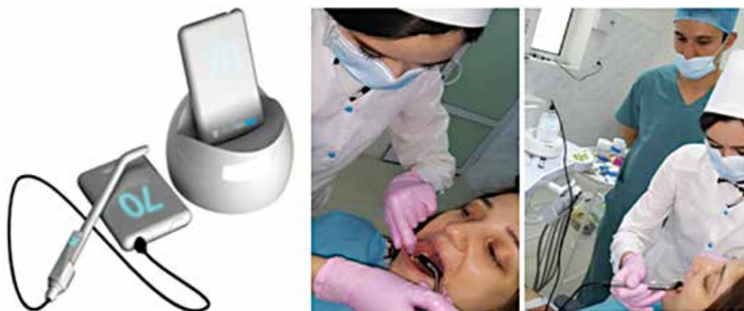
Рис. 5 Частотно-резонансный анализ и измерение функционального состояния костного регенерата с имплантатом (коэффициент стабильности имплантата-КСИ)
