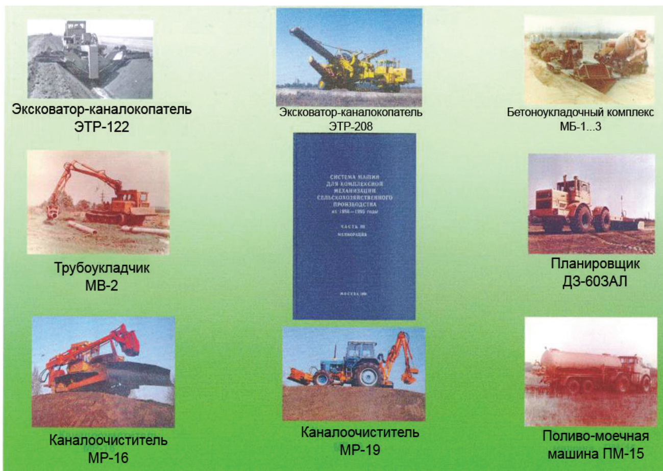
Рис.2. Система машин для комплексной механизации мелиоративных работ
