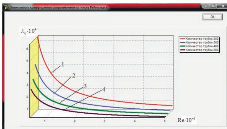
**Рис. 3** Зависимость коэффициента сопротивления для гладких трубки от количество трубки  $n$  и число Рейнольдса  $Re$ : 1)  $n = 200$ , 2)  $n = 300$ , 3)  $n = 400$ , 4)  $n = 500$ .
