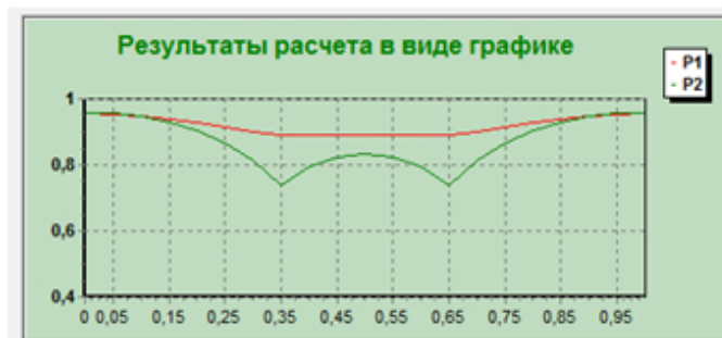
Рис. 3 Результаты расчета при k_1=0.2 д; k_2=0.1 д; k_p=0.00001 д; \mu=6 сп; q=300 м 3 /сут., P_1 = P_2=200 атм.
