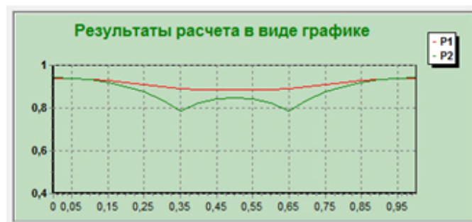
Рис. 2 Результаты расчета при k_1=0.2 ; k_2=0.1 ; k_p=0.00001 ; \mu=4 сп; q=300 м 3 /сут., P_1 = P_2=200 атм.
