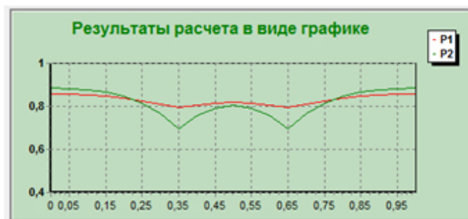
Рис. 6 Результаты расчета при k_1=0.5 д; k_2=0.1 д; k_p=0.00001 д; \mu=8 сп; q=400 м 3 /сут., P_1 = P_2=200 атм.
