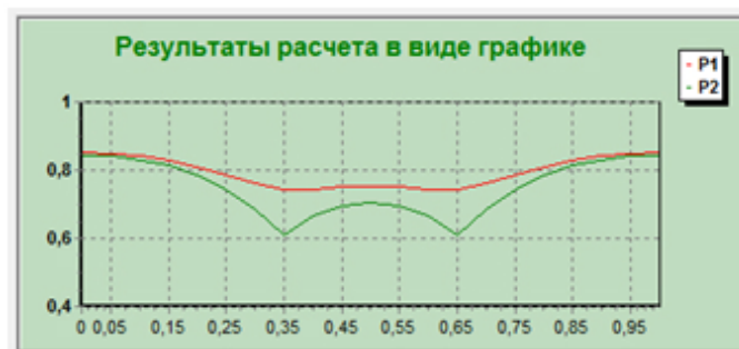
Рис. 8 Результаты расчета за 720 сут. при k_1=0.5 д; k_2=0.1 д; k_p=0.00001 д; \mu=8 сп; q=400\text{м}^3/\text{сут.} , P_1=150 атм. P_2=200 атм.
