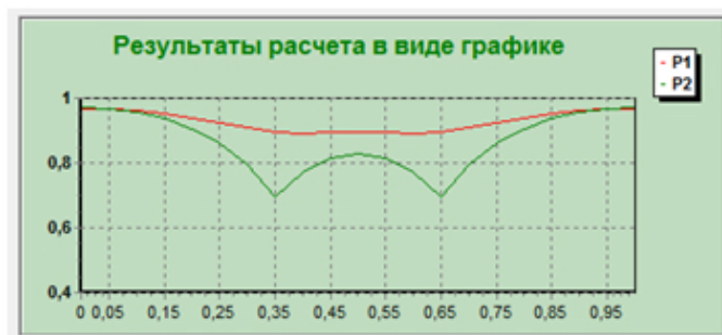
Рис. 4 Результаты расчета при k_1=0.2 д; k_2=0.1 д; k_p=0.00001 д; \mu=8 сп; q=300 м 3 /сут., P_1 = P_2=200 атм.
