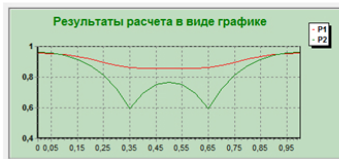
Рис. 5 Результаты расчета при k_1=0.2 д; k_2=0.1 д; k_p=0.00001 д; \mu=8 сп; q=400 м 3 /сут., P_1 = P_2=200 атм.
